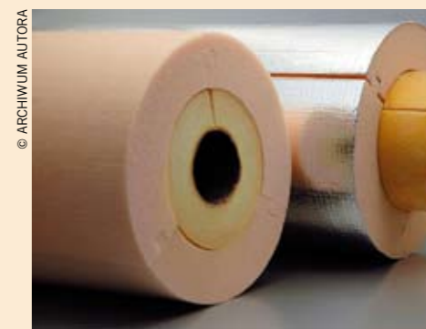
Przykład zastosowania poliuretanu i wełny mineralnej jako otulin termoizolacyjnych na przewody grzewcze (zewnętrzna otulina — poliuretan, wewnętrzna otulina — wełna mineralna). Od lewej: otulina bez płaszczu, po prawej otulina z płaszczem (folia ALU)
