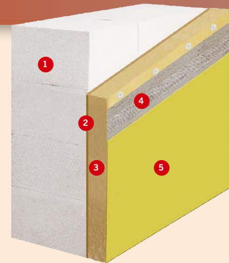
Rys. 1: Model ściany dwuwarstwowej: 1 — ściana nośna, 2 — warstwa klejąca termoizolację ze ścianą nośną, 3 — termoizolacja, 4 — klej wraz z zatopioną w nim siatką zbrojącą, 5 — tynk cienkowarstwowo wraz z zewnętrzną powłoką malarską.
