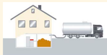
Eksploatacja kotłów na paliwa stałe może być w pełni zautomatyzowana, począwszy od dostarczenia do miejsca składowania paliwa, skończywszy na automatycznym podajniku bezpośrednio do spalania.
